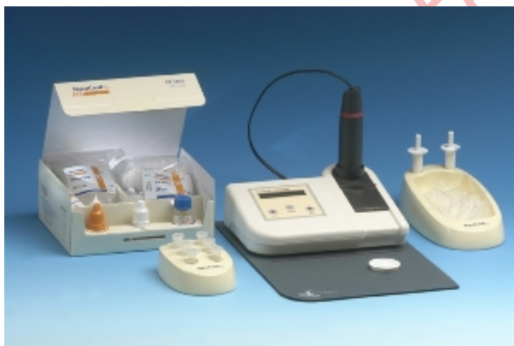
Рис. 5. Внешний вид анализатора Nycocard Reader II для количественного определения D-димеров (с шагом в 100 нг/мл) фирмы Axis-Shield PoC AS, Норвегия
